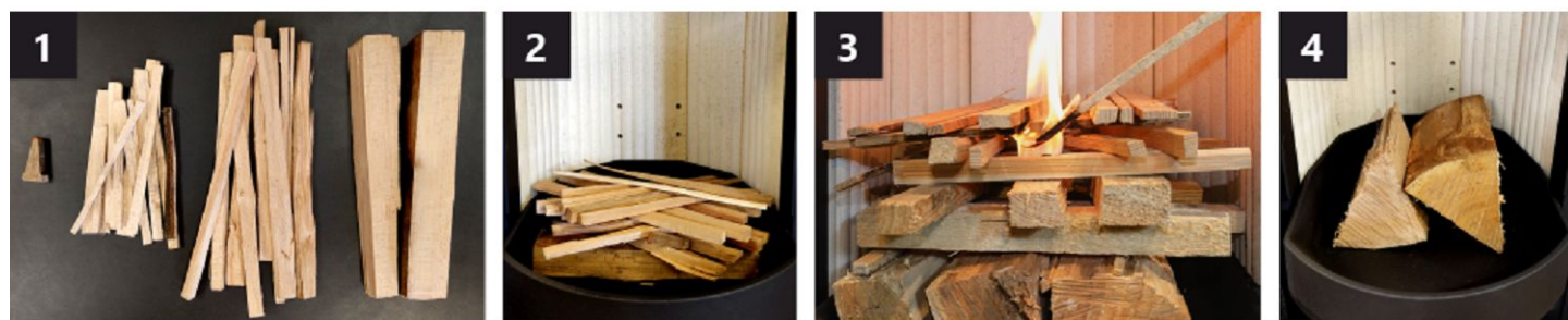
Fig. 1 Procedura di preparazione del legno nella camera di combustione
